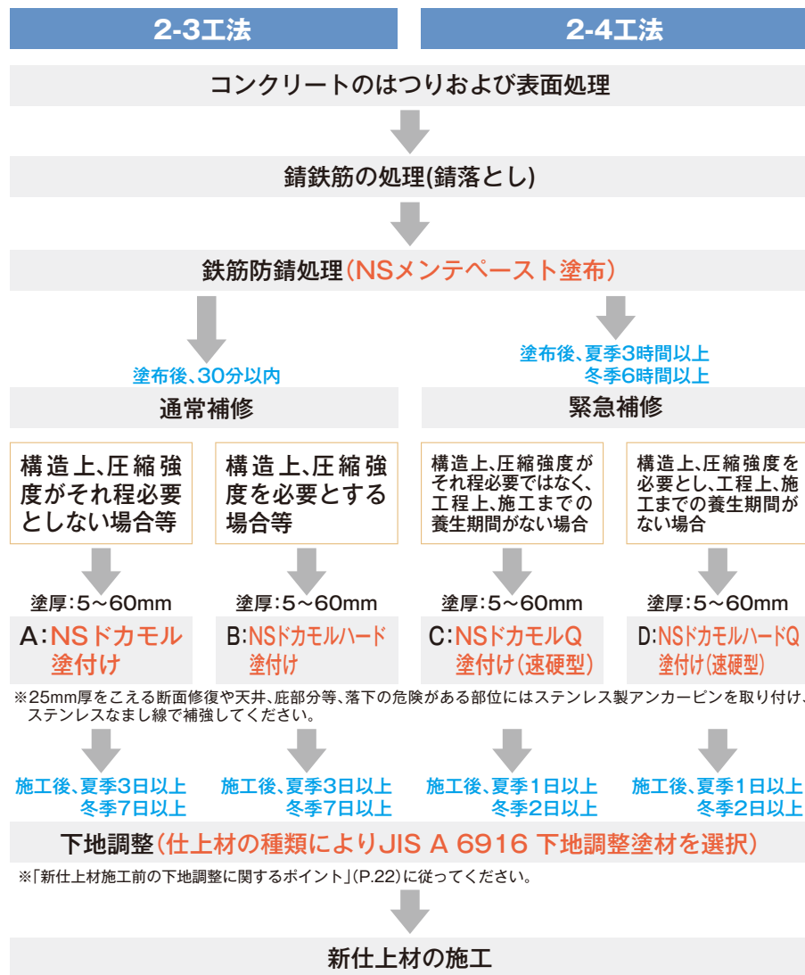
鉄筋防錆処理[NSメンテペースト]
