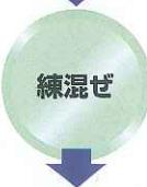
NSポリマーミックス#30 25kgに対し水約6.8ℓを加え、モルタルミキサー・ハンドミキサー等でダマが残らないように十分に練り混ぜてください。
