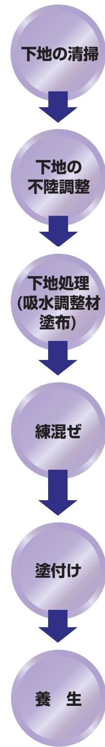
下地のぜい弱層・レイタンス・油分・汚れ等を研磨機または高圧洗浄機を用いて研磨除去し、健全なコンクリート面を露出させてください。
