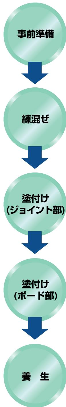
せっこうボード同士を突き合わせて固定し、そのジョイント部にジョイントテープを貼り付けてください。
