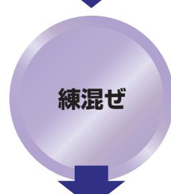
セメント、左官砂、けい砂、MC等はあらかじめ空練り後、所定のNSカチオンフレックスを加えてモルタルミキサー等でダマにならないように十分練り混ぜてください。
